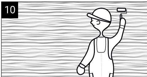
10 Vor dem Lackieren sollten die Platten mit einer Rolle (WELDPRIMER) grundiert werden.
