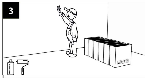
3 Prepara la parete. Applica uno strato di primer alla parete. Assicurati che la superficie sia completamente asciutta e non liscia.
