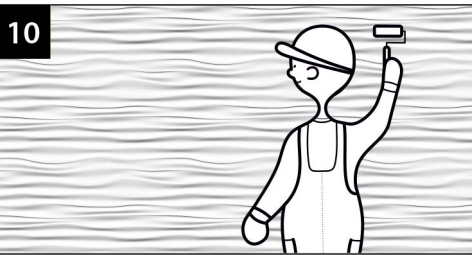
10 Prima di verniciare, applica uno strato di primer WeldPrimer ai pannelli usando un rullo da pittura.
