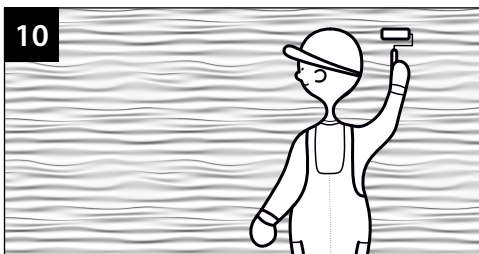
Antes de pintar, los paneles deben imprimirse con WELD PRIMER utilizando un rodillo de terciopelo.
