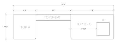
TOP VIEW (Gas & Electrical Conduits Access Points)
