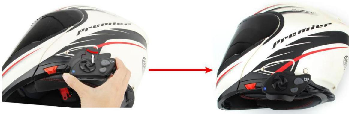
Retire el intercomunicador y presione la parte superior del clip posterior.
