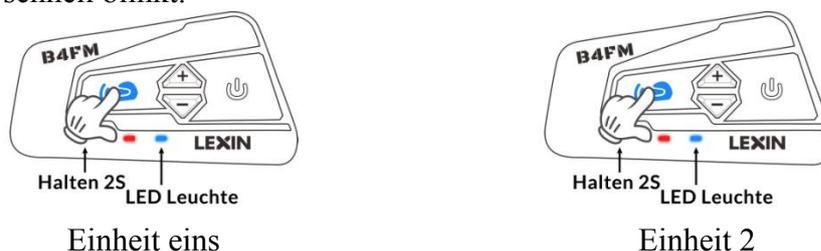
Klicken Sie auf die Intercom-Taste an einem der beiden Einheiten, bis die blaue Leuchte an diesem Gerät schnell blinkt. Sobald die Kopplung abgeschlossen ist, blinkt eine blaue Leuchte an beiden Einheiten blinken (kein rot).
