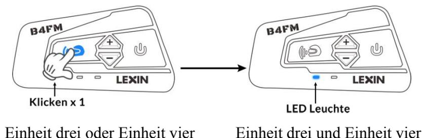
**Tipps: Um Brückeneinheiten anzuschließen, doppelklicken Sie auf die Intercom-Taste. Um die Brückeneinheit mit der Endeinheit zu verbinden, drücken Sie einmal die Intercom-Taste an den Endeinheiten..**
