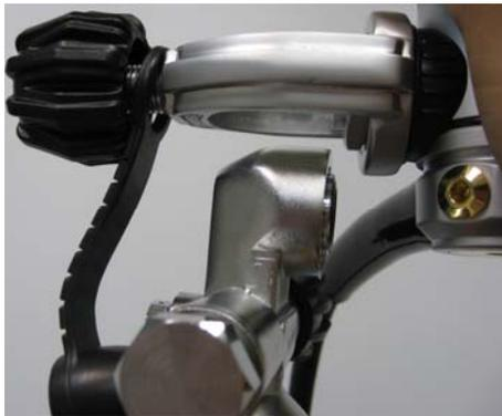
Für DIN-Anschluss: Entfernen Sie die Staubkappe, und richten Sie die Erststufen-Zuleitung auf die Flaschenventil-Öffnung aus. Drehen Sie das Handrad im Uhrzeigersinn bis zum Anschlag.
