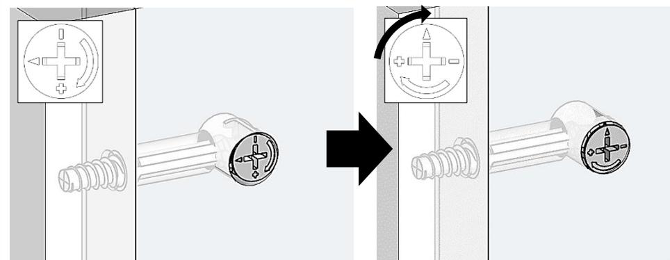
③ジョイントピンが奥までしっかり入りましたら、カムロックをドライバーで時計回りに締めてください。カムロックにより、板が密着し、固定されます。
