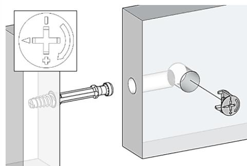
①ジョイントピンが出ている向きにカムロックの矢印を向けて部材の穴に入れます。
