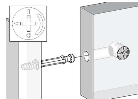
②カムロックを入れた部材の側面にある穴にジョイントピンを差し込みます。
