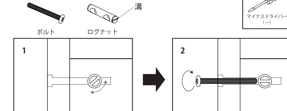
ボルトを差し込む前にマイナスドライバーをログナットの溝の向きがボルトと一直線になるように回して調整します。
