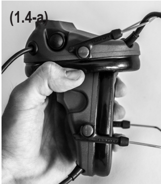
1.4 Girar 90 grados la copa derecha (la que no tiene el micrófono de pértiga) para desmontar la guía del brazo de la misma tal como se muestra en las figuras 1.4-a, 1.4-b y 1.4-c. Esta operación requiere poca fuerza.
