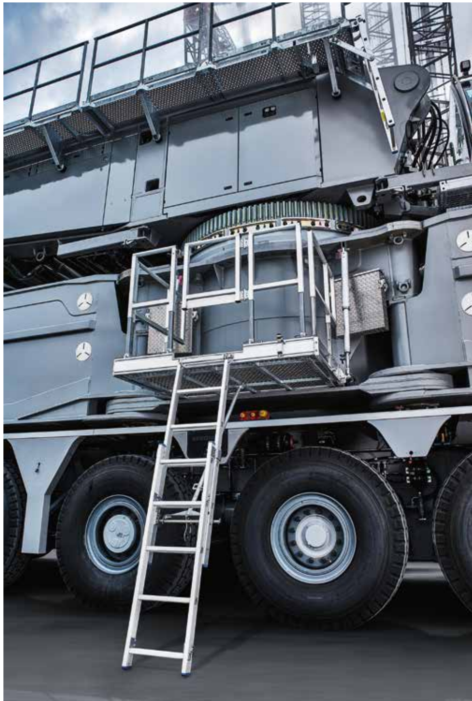
Podest mit Schiebeleiter und Stütze für Mobilkrane, Kunde Liebherr Ehingen
