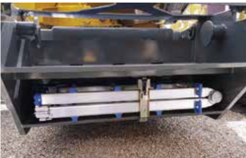
Teleskopleiter mit Klapptraverse, platzsparend direkt am Fahrzeug
