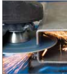
Beidseitiges Schleifen und erstaunliche Eintauchtiefe
