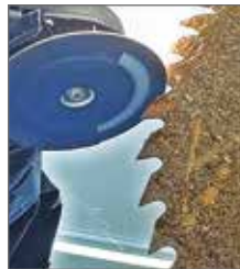
Entgraten, Feinschleifen und Anfasen
