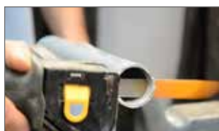
2,5 er Zahnung ermöglicht selbst Schnitte in Metall bis 3 mm
