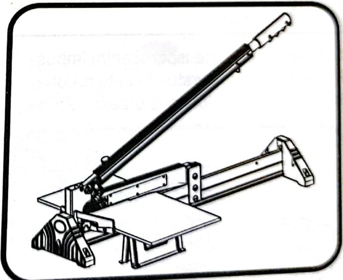
Materijal polegnite između oštice i baze kao što je prikazano na slici. Materijal pridržavajte pridržnom šipkom. Ručku za guranje pritisnite posve prema dolje. Učvršćenje  $0 - 45^\circ$  postavite kao što je prikazano na slici. Materijal polegnite između oštice i baze i pridržavajte ga pridržnom šipkom. Ručku za guranje pritisnite posve prema dolje (sljedeća slika).
