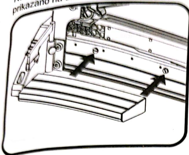
Uporište pričvrstite na napravu kao što je prikazano na slici.
