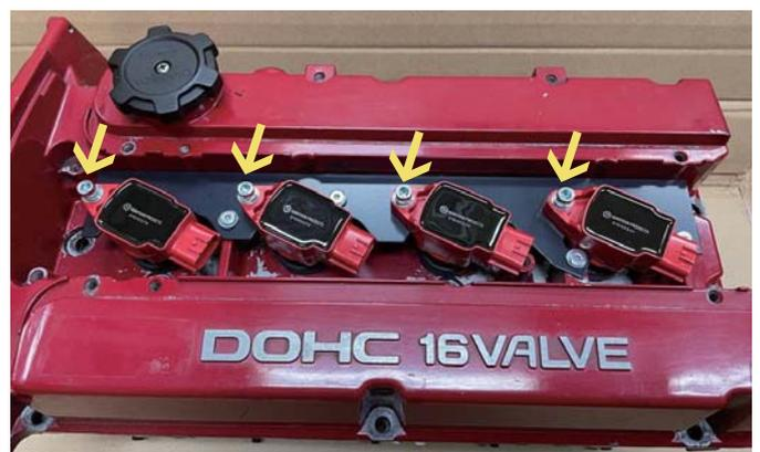
6. ③エンジンハーネスを取り付け、手順5で仮止めの④六角穴付きボルト (M6x25)を締め付けてください。
