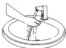
El agua fluirá automáticamente cuando usted coloque las manos en la zona de detección.
