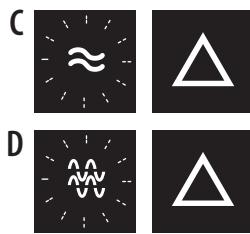
**motore guasto** (*se lampeggia il simbolo "C" significa che il guasto riguarda la pompa 1; se lampeggia il simbolo "D" il guasto riguarda la pompa 2*)
