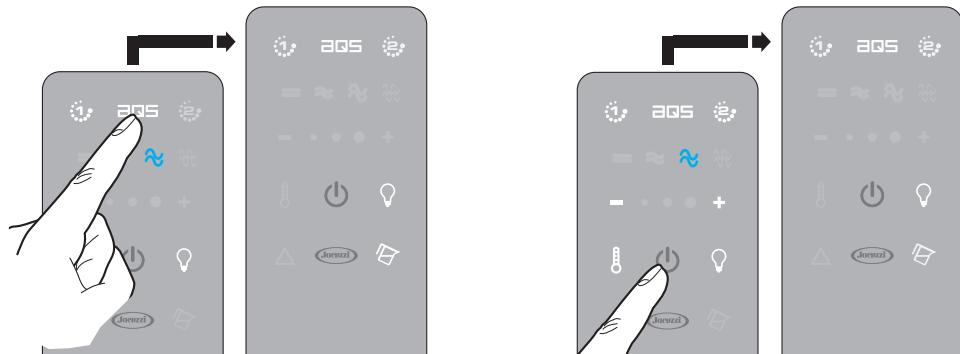
■ Après l'utilisation et avant de vider la vasque, éteindre **TOUJOURS** l'hydromassage ; éteindre aussi l'interrupteur principal installé sur la ligne d'alimentation de la vasque.
