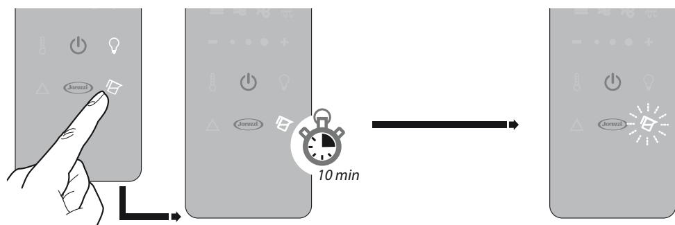
La fonction dure environ 10 minutes et est entièrement automatique. Environ une minute avant la fin de la fonction, la pompe s'active de nouveau pour rincer les tuyaux.
