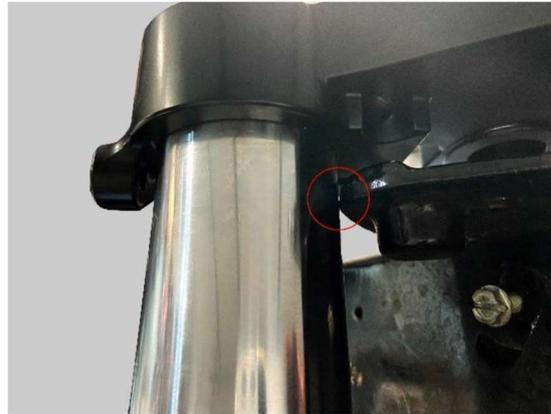
La retirada del depósito de gasolina será requerida. ¡Enmascare y cubra todas las áreas fuera de la lengüeta de bloqueo de la horquilla 2009-2013 necesitan también el perforado de dos agujeros de montaje! Alineación y asegure del tope de la horquilla como se muestra:
