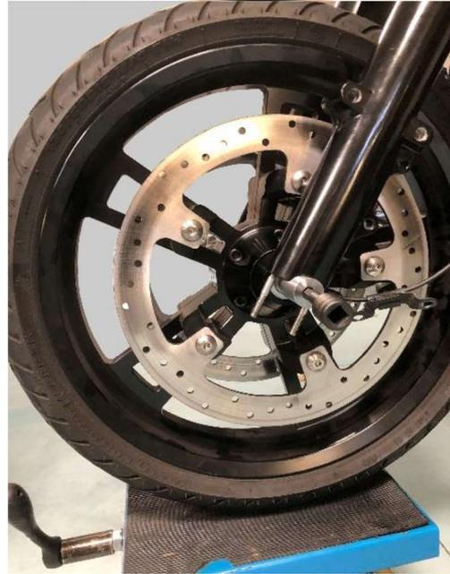
Compruebe si los centros de los cojinetes están alineados con los deslizadores de las horquillas. Engrase ligeramente el eje y deslice suavemente el eje en el interior. Ajuste la altura de la llanta con el elevador de tijera, tanto como sea necesario. El eje debería correr en todo el camino del manguito en el deslizador de la horquilla derecha, quitando el uso excesivo de fuerza. Si se queda atrapado en el espaciador del lado derecho, moviéndolo un poco se resuelve.
