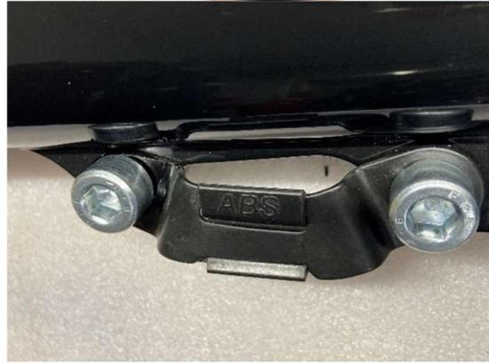
Instale en el deslizador de la horquilla
