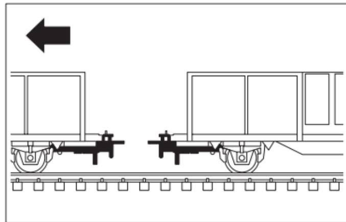
Relex-Kupplung austauschbar gegen Kurzkupplung mit Norm-Aufnahme. Der größere Pufferabstand erleichtert den Spielbetrieb auf kurvenreichen Anlagen und die Kombination mit älteren Fahrzeugen.
