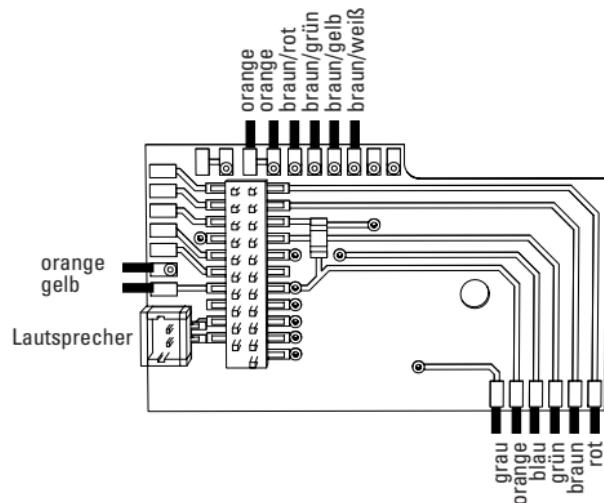
Wenn die Beleuchtung mit dem Rückleiter über die Fahrzeugmasse erfolgt, kann es teilweise zum Flackern der Beleuchtung kommen. Wenn dies nicht erwünscht ist, muss die Beleuchtung isoliert werden. Wir empfehlen, die Glühlampe gegen die Steckfassung 604180 und Glühlampe 610080 zu tauschen. Der Rückleiter wird dann an das orange Kabel angeschlossen.
