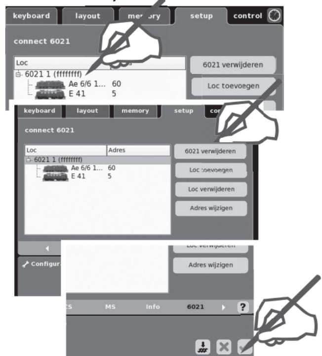
De Connect 6021 kan pas na het opnieuw opstarten van het Central Station geactiveerd worden.
