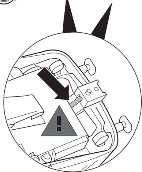
Stromleitende Kupplung • Current-conducting couplers
