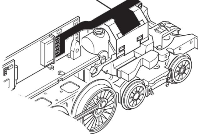
Nach dem Schmieren der Schnecke Kabel und Flexleiter wieder mit Klebeband fixieren.
