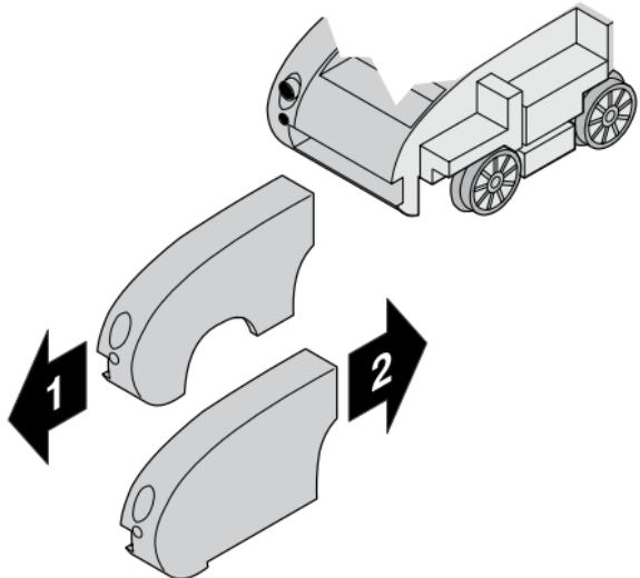
Vor dem Wechsel der Frontschürzen Lokgehäuse entfernen!
