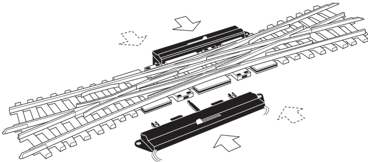
Einbau mit Unterflur-Zurüstsatz 7548.
