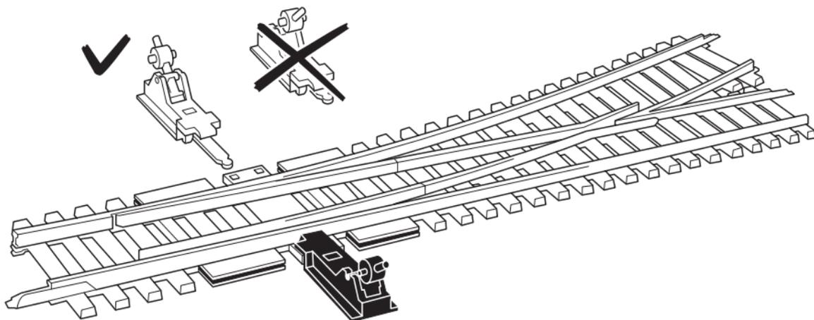
Vor dem Anstecken des Antriebs unbedingt den Hand-schalthebel entfernen. Beim Anstecken des Antriebs 75491 ist auf richtige Position des Schaltfingers zu achten.
