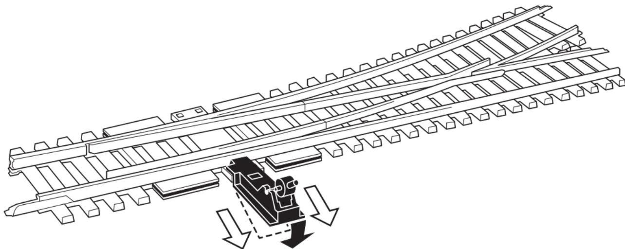
Beim Anstecken des Handschalthebels rechts oder links ist auf die richtige Position des Schaltfingers (Abb.) zu achten.
