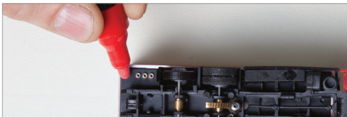
Abb. 12: Polung der Ladebuchse markieren, Fahrzeuggehäuse außen
