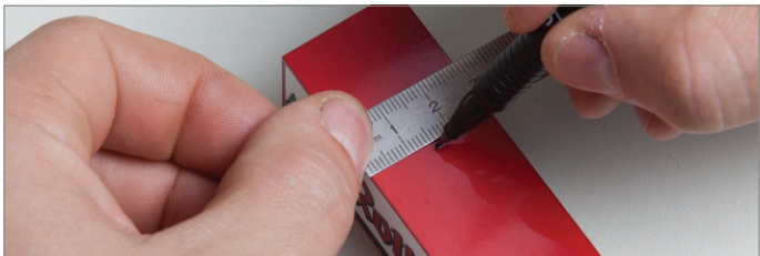
Abb. 36: Position der Ultraschallkapsel anzeichnen
