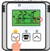
Halten Sie die **MENU** Taste länger als 5 Sekunden gedrückt, um die Tastensperre zu aktivieren.
