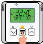
1x Taste **MENU**, dadurch wird die Hintergrundbeleuchtung des Displays aktiviert
