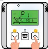
Die Solltemperatur beginnt zu blinken. Über die Taste oder kann die Solltemperatur geändert werden.
