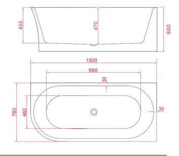
A. 1634242 VERSA LEFT HAND 2 SIDED CORNER 1500MM X 780MM X 600MM HIGH B. 1634243 VERSA RIGHT HAND 2 SIDED CORNER 1500MM X 780MM X 600MM HIGH
