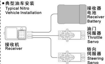
使用双面泡棉胶将接收机按装于您的车内,双面泡棉胶使接收机固定升压升接收机不受振动。将天线放置在垂直天线管里并远离的汽车。
