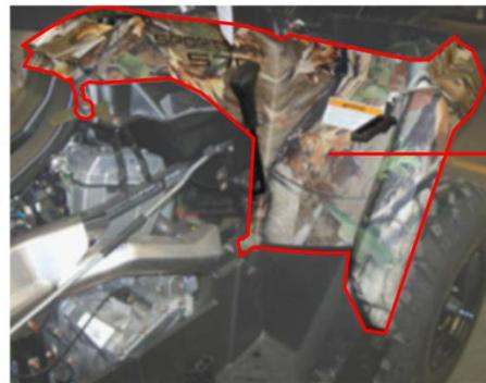
**Étape 4 :** Retirer le bloc de guidon, le support de montage du boîtier, la bague de direction et le réservoir à essence. Débrancher le faisceau de câbles et le raccord. Faire attention au carburant qui pourrait être renversé.
