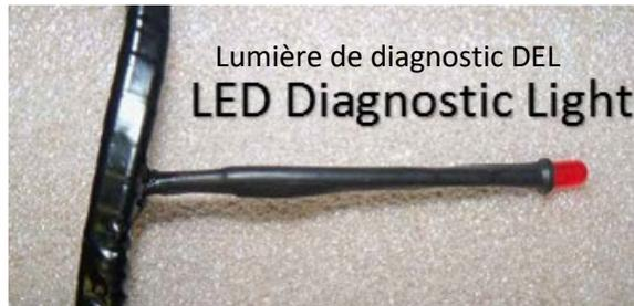
Si une pièce électronique ne fonctionne pas correctement, le système créera un code qui permettra d'identifier le problème. Chaque code d'erreur s'affiche par une série de clignotements avec un voyant d'erreur. En cas de code d'erreur, une lumière le signalera.
