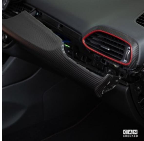
Entferne die Kreuzschlitzschraube (rot) und benutze das Montagewerkzeug um die Verkleidung am Armaturenbrett auf der gesamten Breite, um die Lüftungsdüse, bis zur Lenksäule vorsichtig nach hinten herauszuhebeln.
