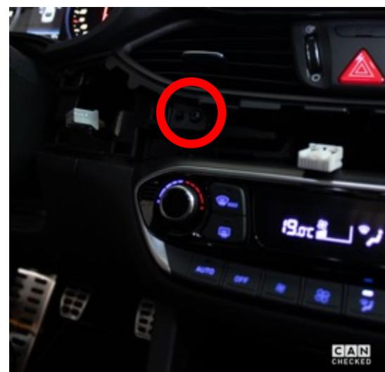
Nun kannst du die beiden Kreuzschlitzschrauben die die Lüftung halten (rot) demontieren und die Lüftung nach hinten herausziehen. Auch hier ist wieder auf die beiden Stecker hinter dem Warnblinkschalter achtzugeben.
