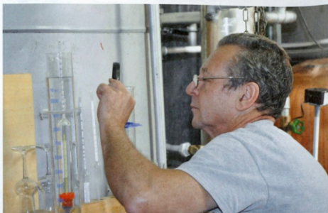
Den Alkoholgehalt liest Martin Schegg präzise mit der Lupe vom Alkoholmesser ab.
