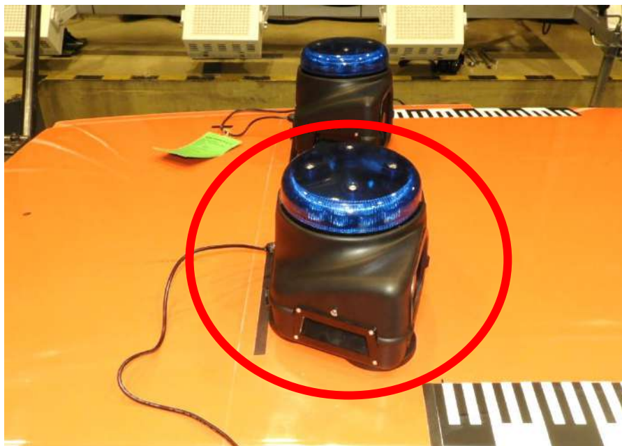
Abb. / Figure 2: Positionierung vor Test. Die rot umrandete Warnanlage ist die Ausführung mit 4 Magnetfüßen. / Positioning before test. The warning system outlined in red is the version with 4 magnetic feet
