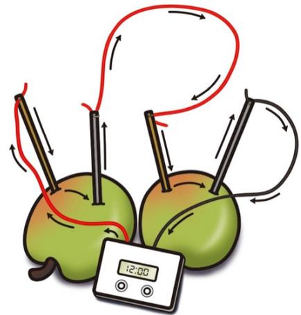
Une **réaction chimique** a lieu à l'intérieur de la pomme pour compléter le circuit. Les électrodes en laiton se dissolvent dans le jus de pomme et émettent de petites particules appelées **électrons**. Ces électrons se déplacent du jus jusque dans l'électrode en zinc et, ce faisant, elles créent un **courant électrique**.
