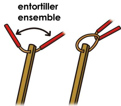
3. Attacher chaque extrémité du fil rouge aux autres électrodes en zinc et en laiton.
