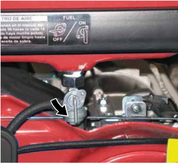
Figura 17 – Válvula de cierre del combustible en la posición ON (encendido)
