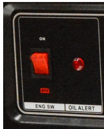
Figura 24 – Interruptor de control del motor
