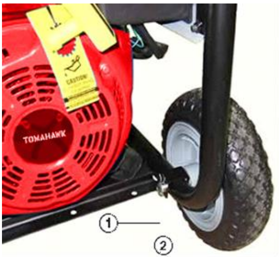
Figura 6 – Ensamble las ruedas al bastidor
