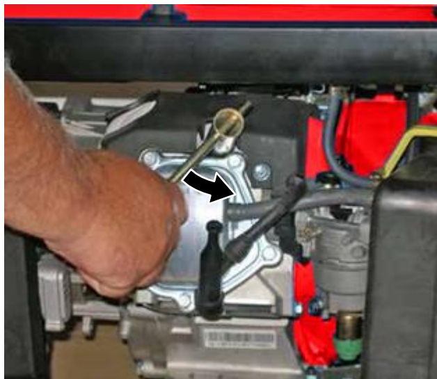
Figura 37 – Procedimiento para extraer la bujía
