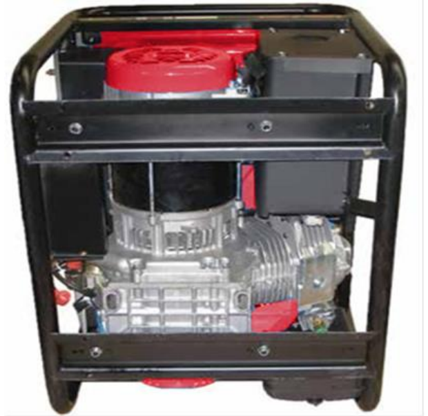
Figura 4 – Incline el generador de costado
