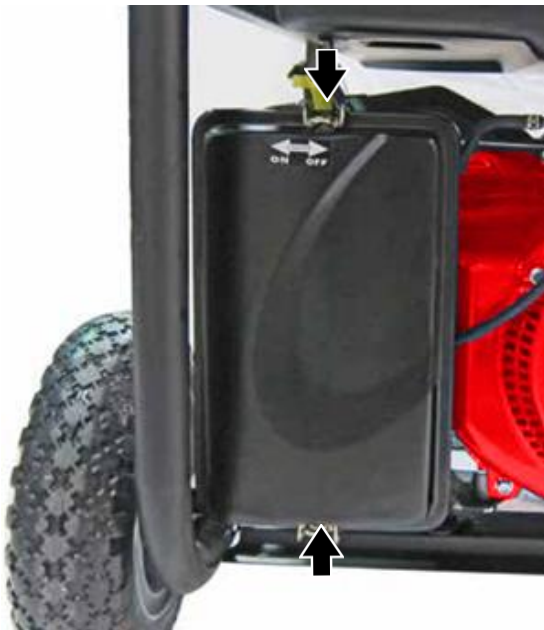
Figura 35 – Instalación de la Tapa del Filtro de Aire
