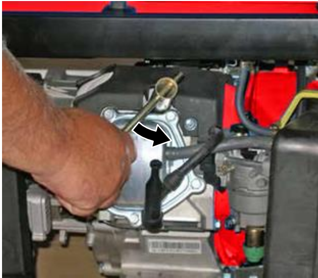
Figura 37 – Procedimiento para extraer la bujía
