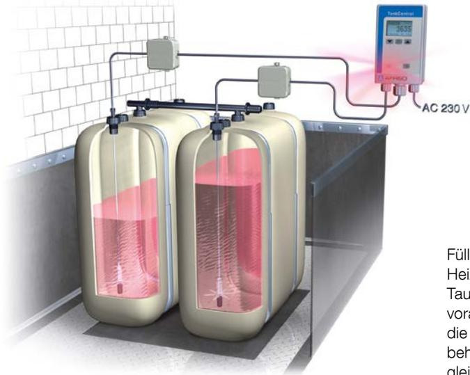
Füllstandüberwachung von zwei miteinander kommunizierenden Heizöltankbehältern. Hierzu befindet sich in jedem Tank eine Tauchsonde. Ist die Füllstanddifferenz der Tanks über einem vorab definierten Wert, wird Alarm ausgelöst. Die Ursachen für die ungleichmäßigen Füllstände können vor dem Tankvorgang behoben werden. Der drohende Überfüllschaden aufgrund ungleichmäßiger Füllstände ist gebannt.
