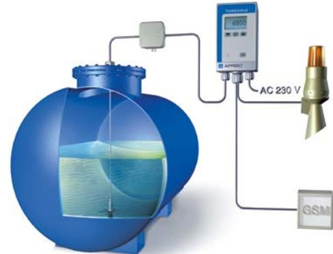
Füllstandüberwachung in einem Regenwasserbehälter im Außenbereich. Mit angeschlossener Warnlichthupe als zusätzlichem Alarmgerät am Aufstellort und TankControl 10 innerhalb des Gebäudes. Zudem ist ein Schwimmerschalter als Kanalrückstauwächter anschließbar. Die Anlage ist optional erweiterbar um eine Überwachung durch Ereignismeldesysteme auf Basis GSM.
