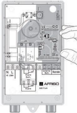
3. Drücken Sie die Antenne des EnOcean®-Funkmoduls in die drei Gehäuseausparungen am Produkt ein.
