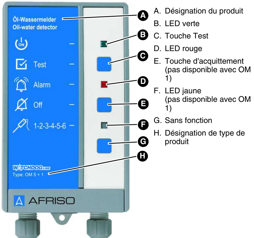
Figure 3: Unité de commande
