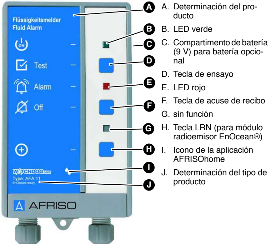
Figura 2: Unidad de control
