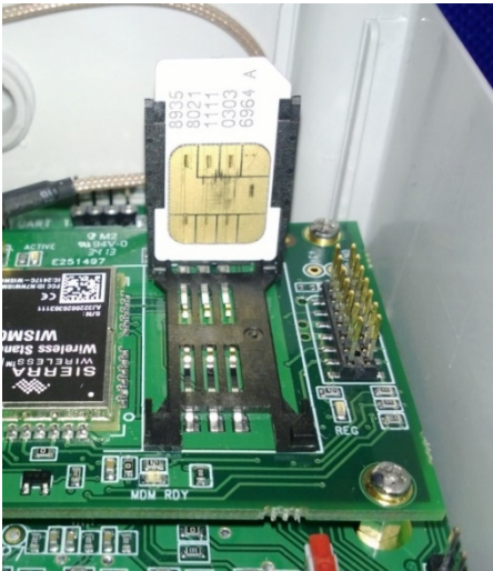
Bild 10: Installation der SIM-Karte im EMS 442
