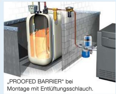
**Anwendung** Für Einstrangsysteme mit Rücklaufzuführung in Ölfeuerungsanlagen zur kontinuierlichen Entlüftung. Geeignet für die Medien Heizöl EL (DIN 51603-1) und Dieselmotortreibstoff (EN 590) sowie Bioheizöl und Biodiesel mit bis zu 100 % FAME und pflanzliche Öle (Rapsöl). Auch für den Einsatz in hochwassergefährdeten Gebieten. Flow-Control 3/K HT ist empfehlenswert bei Montage unterhalb des max. Heizölpegels im Tank und immer, wenn besondere Sicherheit gewünscht wird.
