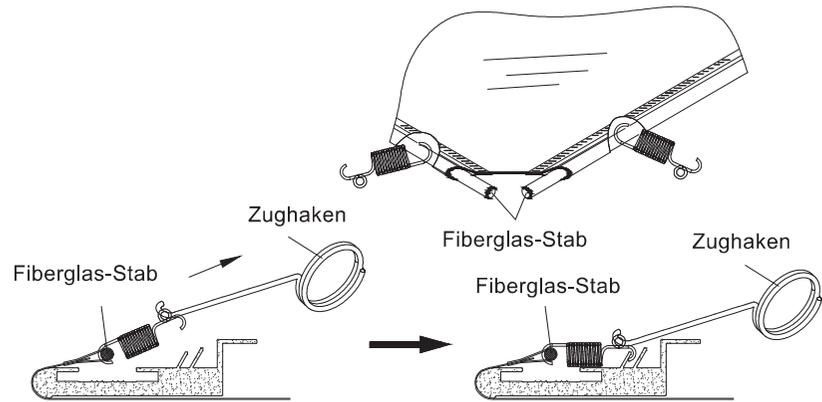
4.5 Nachdem Sie alle Federn gespannt haben, stellen Sie die Leinwand auf und prüfen Sie, ob die Leinwand insgesamt Falten- & Wellenfrei ist. Bei Unebenheiten muss die Feder lokal nachgespannt werden, bis alle Unebenheiten beseitigt sind. 4.6 Legen Sie die Leinwand nun wieder hin, damit der äußere Rahmen installiert werden kann.
