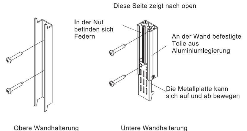
**6.2** Befestigen Sie die Wandaufhängungen entsprechend der Größe der Leinwand an der Wand. Erforderliche Werkzeuge: Wasserwaage, Bohrhammer, Bleistift, Leiter usw. Wie unten dargestellt, setzen Sie die Halterungen bitte 30cm nach Innen.
