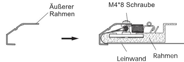
5.2 Stellen Sie sicher, dass die Ecken ohne Spalt zusammen liegen (Gehrung). Ziehen Sie dann die Schrauben fest. Arbeiten Sie sich so von Ecke zu Ecke.
