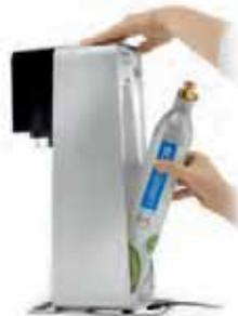
Entfernen Sie die Schrumpffolie und den Deckel vom Ventil des SodaStream CO2- Zylinders. Setzen Sie die Unterseite des CO2- Zylinders in das Loch auf der Unterseite des Trinkwassersprudlers, indem Sie diesen leicht nach vorne kippen. Drücken Sie den Zylinder anschließend nach vorne, damit der Kopf des Zylinders das Ventil des Trinkwassersprudlers erreichen kann.
