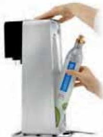
Rimuovi il sigillo termoretraibile e il coperchio di plastica dalla valvola del cilindro. Inserisci il cilindro nella parte posteriore del Gasatore inserendo prima la base del cilindro e poi il corpo del cilindro, inclinando leggermente la testa in avanti del gasatore per permettere alla valvola di posizionarsi sotto il bordo superiore.
