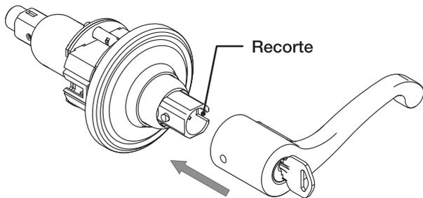
Empuje la manija de la palanca por sobre el chasis hasta que se oiga un chasquido
