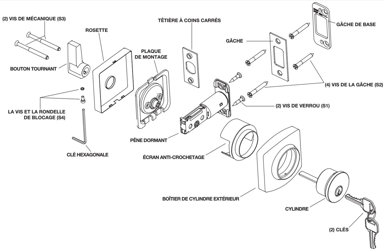
• POUR LES PORTES DE 35 mm (1-3/8 po) À 45 mm (1-3/4 po) D'ÉPAISSEUR •
