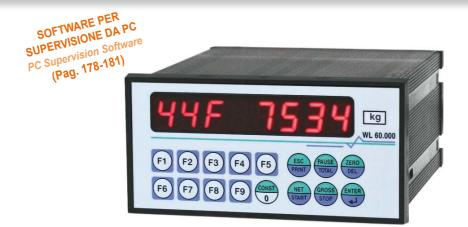
Indicatore di peso in custodia a norme DIN per montaggio a fronte quadro. Dimensioni: 72 x 144 x 170 mm (profondità d'incasso compresi cablaggi seriale e morsettiere). Foratura 67 x 139 mm. Display semialfanumerico a 8 cifre da 14 mm, a 7 segmenti. Tastiera a membrana a 16 tasti con buzzer. Grado di protezione del frontale IP54. Orologio calendario su scheda madre con batteria tampone.
