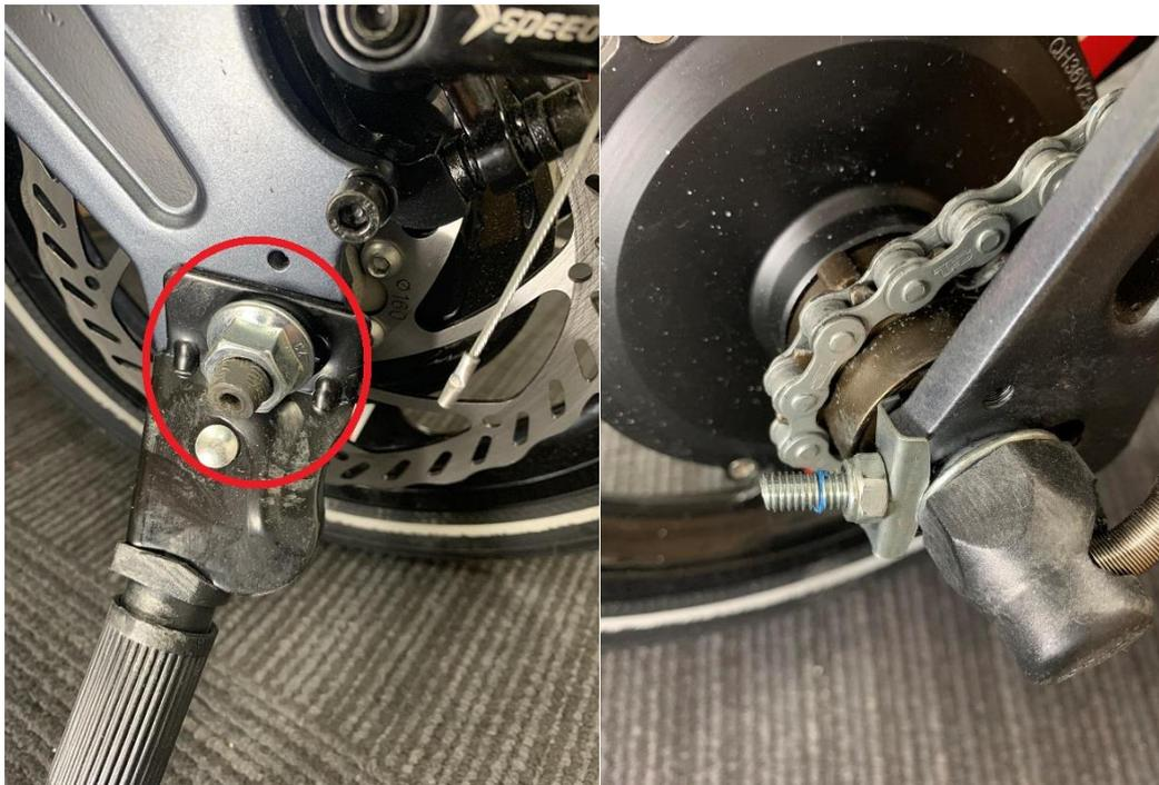
④チェーンを外します。チェーンは張っている状態なので、てこを使ってチェーンを持ち上げるなどして外してください。
