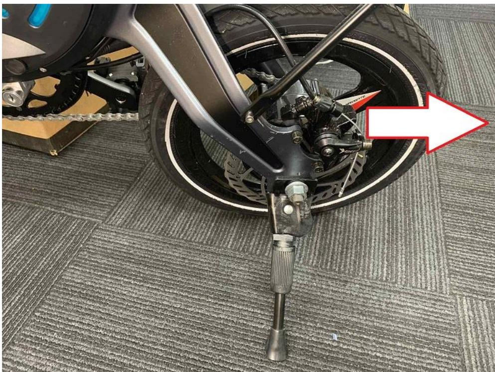
チューブ交換は一般的なシティサイクルと同じです。タイヤレバーを使用しタイヤを外してください。
