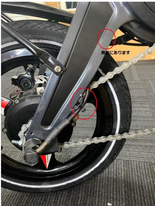
②写真にあるコネクタを抜きます。差し直す時はソケットとコネクタに矢印があるので位置を合わせてください。
