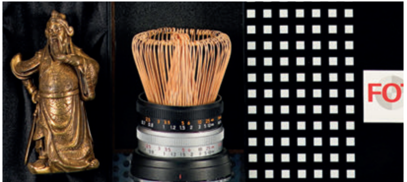
RAND-DETAIL 3,5/85 mm Abblenden verbessert die Auflösung am Rand.
