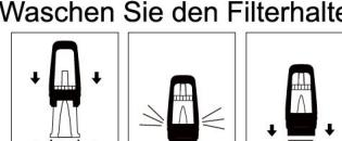
5. Setzen Sie den Wasserfilter in die beiden Teile des Filterhalters ein. Stellen Sie sicher, dass sie fest verbunden sind.
