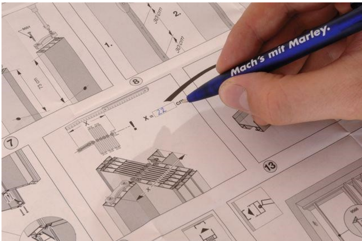
Afbeelding 24 van 37: ... en voer deze in de montage-instructies in. Aandacht! Meet voor het invoeren 2 cm tot de maat
