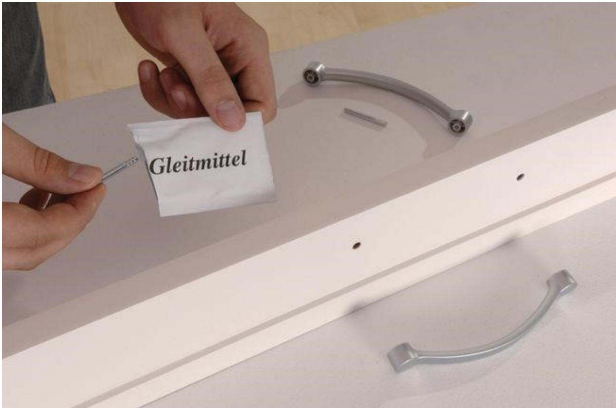
Afbeelding 11 van 37: De deurkruk is gemonteerd met twee gegroefde pennen. Deze stap is gemakkelijker als u de gegroefde pennen aan beide kanten lichtjes smeert.
