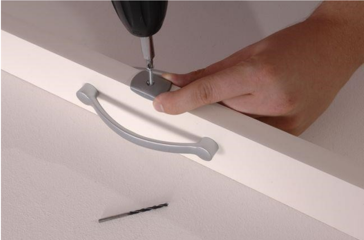
Afbeelding 13 van 37: Het sluitstuk wordt in het midden van de handgreep vastgeschroefd.
