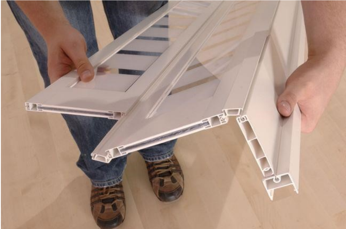
Afbeelding 18 van 37: Nu worden de lamellen tegen elkaar geschoven. Begin met het slotprofiel, gevolgd door een halve lat, een scharnierende staaf en vervolgens een glazen lat.
