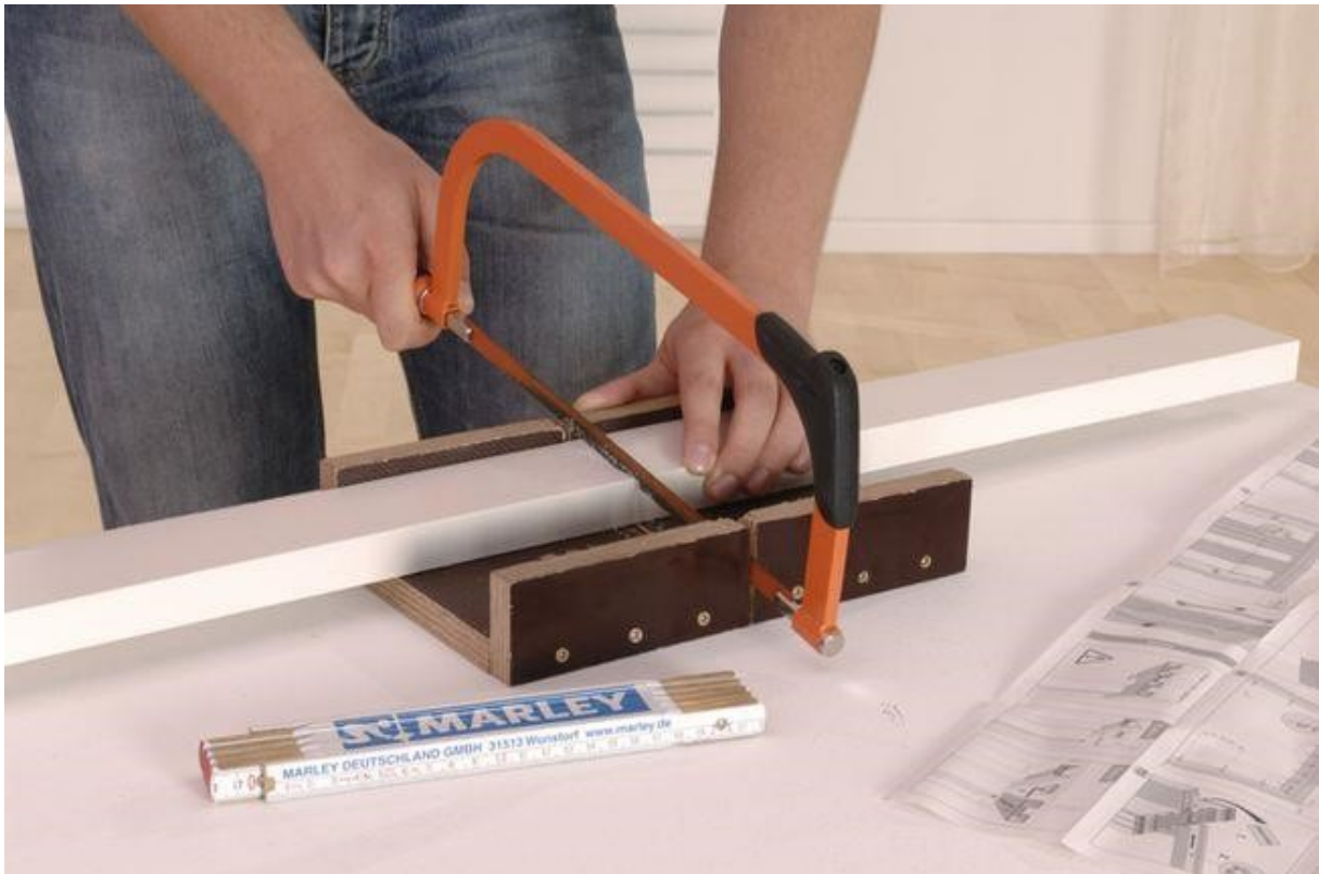
Afbeelding 5 van 37: Vervolgens kunnen de rails met een fijngetande handzaag worden ingekort.
