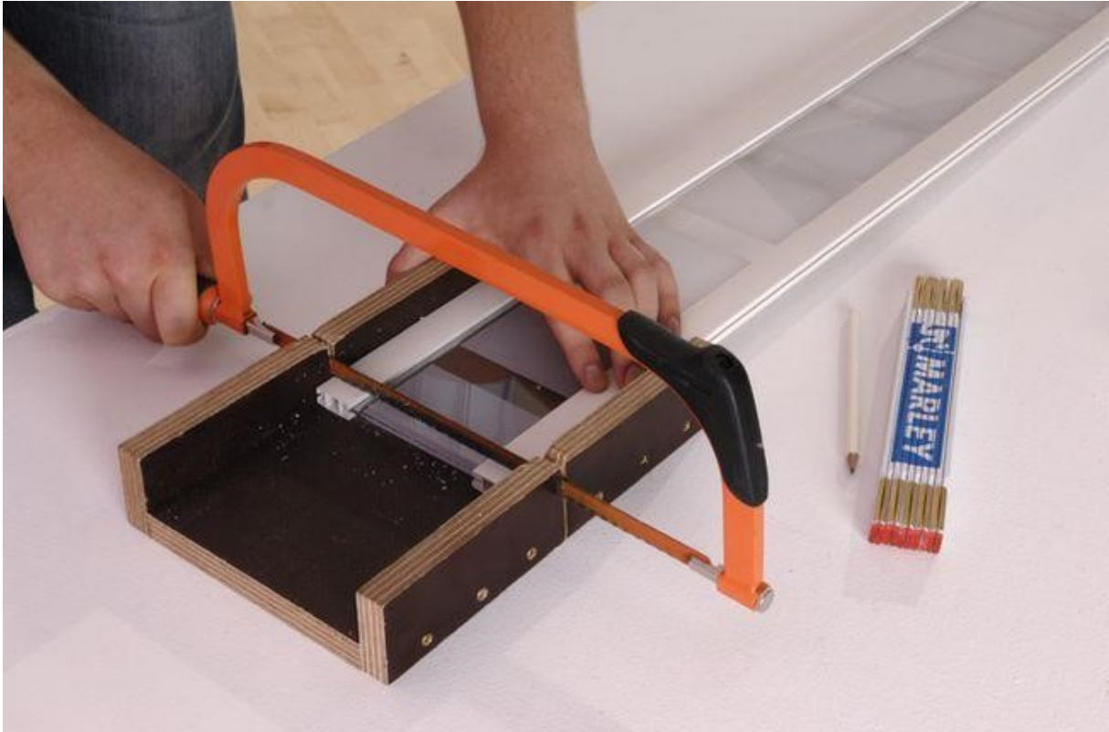
Afbeelding 7 van 37: ... en de lamellen van onderaf inkorten met een fijngetande zaag.
