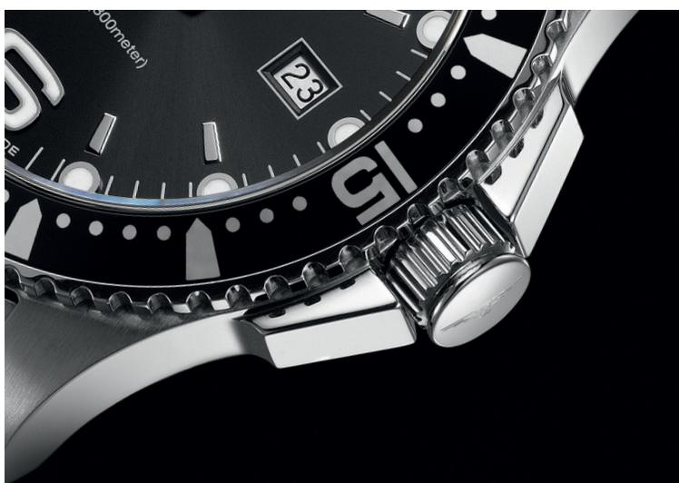
Correlativamente al fondo atornillado, el modo de construcción de la corona concurre a garantizar la estanqueidad del reloj. Se trate de ajustarlo o de darle cuerda (en los modelos mecánicos), una abertura en la caja se revela imperativa. Esta abertura es entonces una puerta de entrada potencial para el agua y el polvo.
